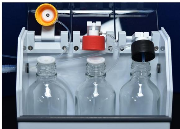
Elite Etch设计成适合在通风柜操作，同时保持所有必要的安全特征。通过使用热交换系统，废酸被冷却到90 °C以下，以允许使用单个废酸瓶。Elite Etch使用3个标准500毫升瓶子，它们随系统提供。
