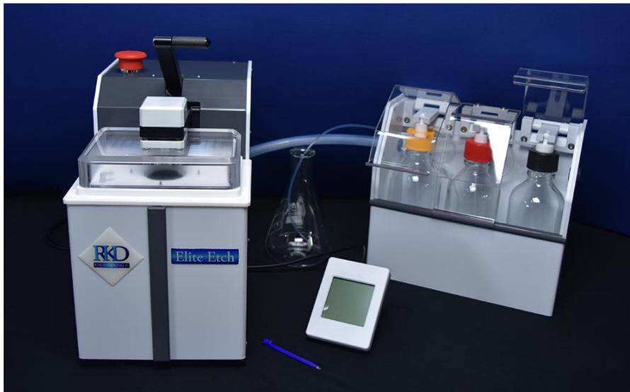
RKD Engineering的Elite Etch融入了最新的创新。蚀刻头采用优质碳化硅制造，具有极高的耐酸性和耐温性。与活性氮气监测和清除系统相结合，这种整体式设计可减少每次去封装过程后留在蚀刻头上的残酸产生的发烟。碳化硅蚀刻头具有很高的热导率使加热时间缩短。
